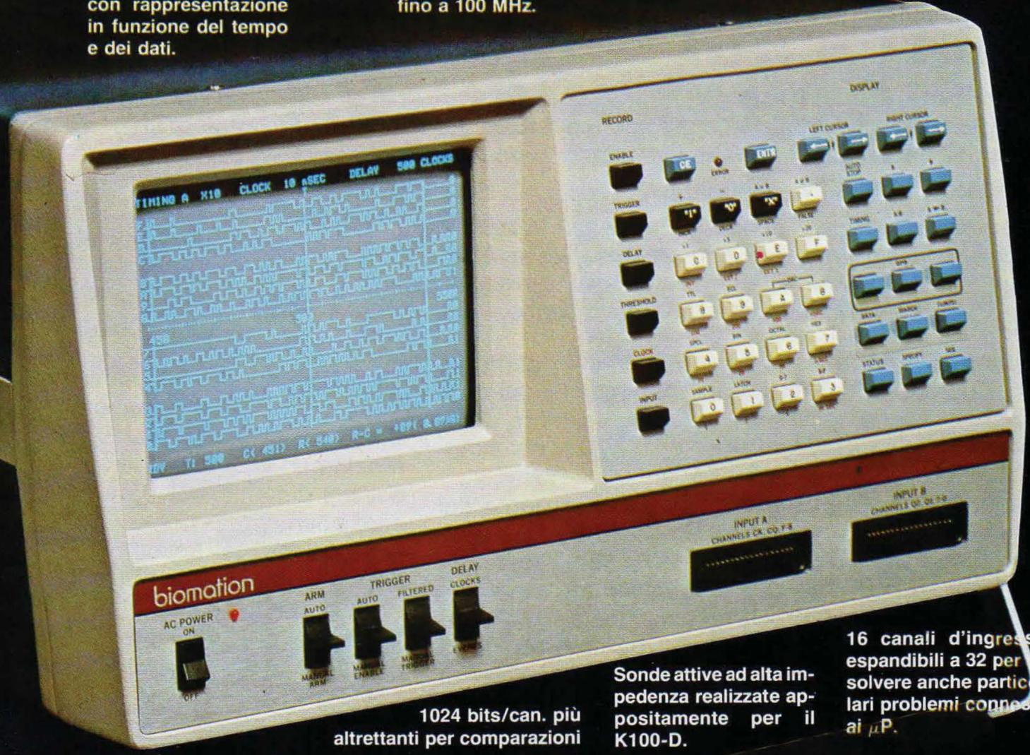
16 canali d'ingresso espandibili a 32 per risolvere anche particolari problemi connessi ai  $\mu P$ .
